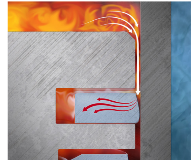
Fig. 2 : Pression de gaz sur la surface de glissement du segment
