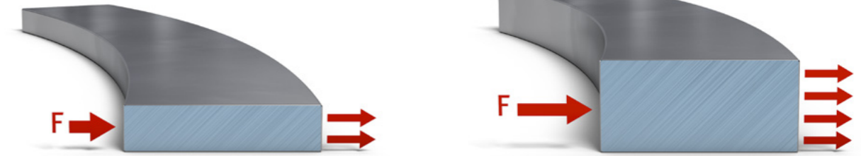
Fig. 2 et Fig. 3 : Tension du segment et force d'appui spécifique
