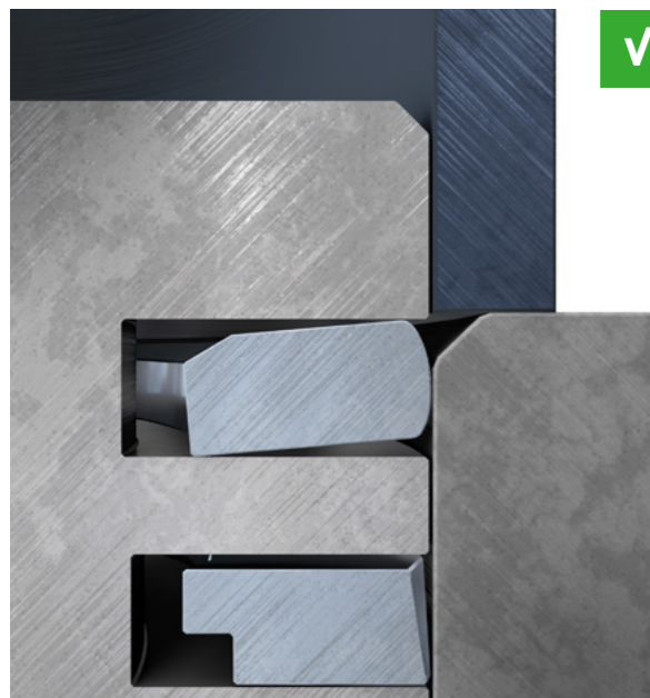
Fig. 2 : Petit chanfrein sur l'alésage de cylindre – le segment de piston glisse sur l'interstice
