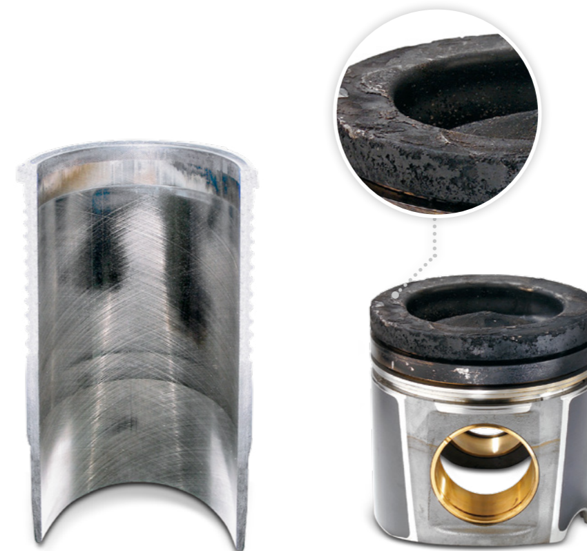
Fig. 2 : Zones brillantes et polies dans la partie supérieure du cylindre
