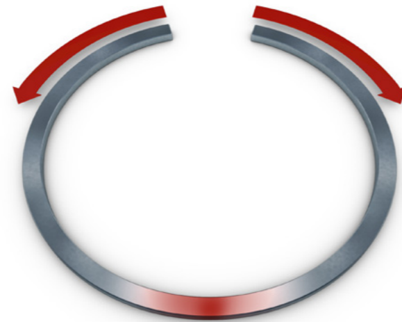
Fig. 1 : Écartement excessif du segment de piston
