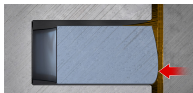
Fig. 3 : Surface de glissement bombée asymétriquement
