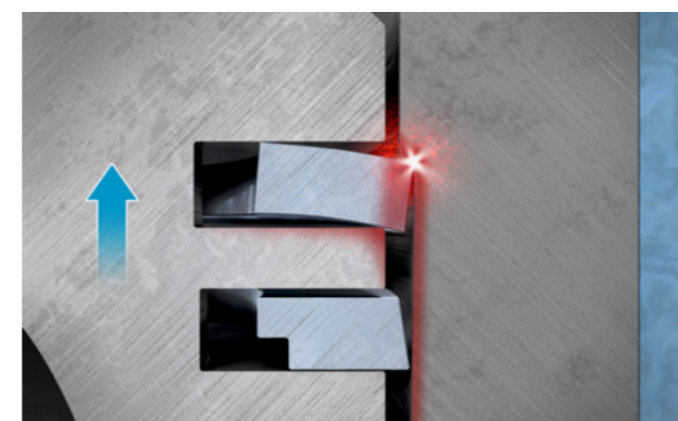
Fig. 3 : Cognement du segment de piston avec un piston neuf
